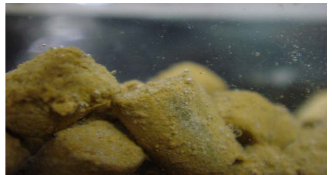
図-5 硫黄造粒物から発生する脱窒による気泡
