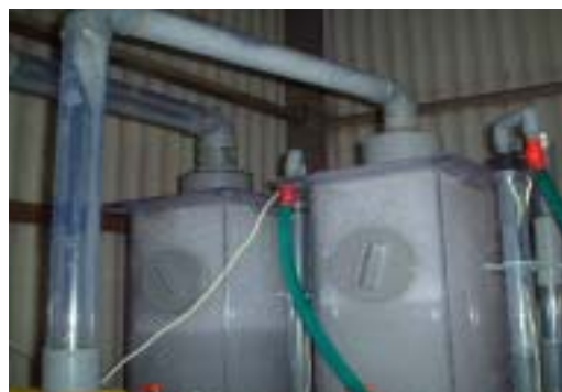
図5：泡沫浮上分離装置
