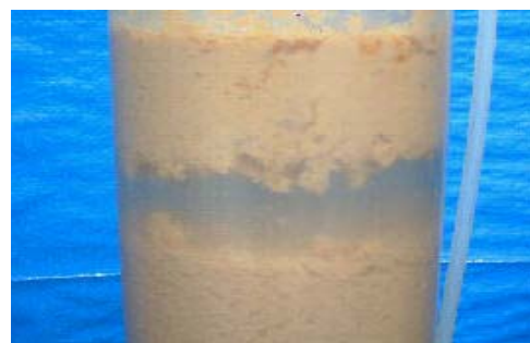
図-3 油と汚泥が混ざった処理状態
