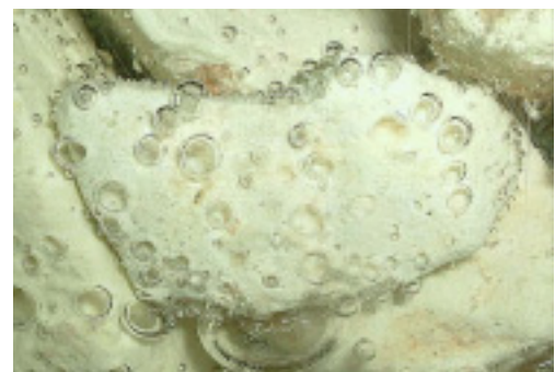
図 - 2 硫黄造粒物に付着した微細気泡
