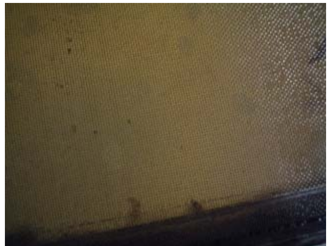
図 - 5 逆洗浄後のフィルター
